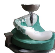
5. Положення свердлильної втулки
